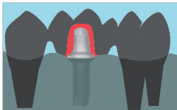
Abb. 4: Der Sicherheitsabstand zwischen Implantat und Schutzmaßnahme sollte ca. 1,5 mm betragen.
